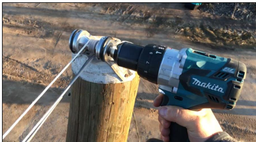
Figura 2. Motor adaptado mediante un taladro.
